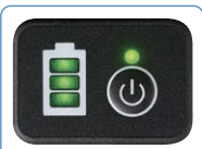
電源スイッチパネル
