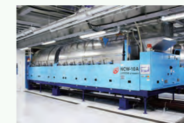
最新の連続洗濯機
